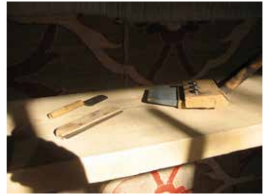
Outils de tassage et de coupe / Tamping and cutting tools
